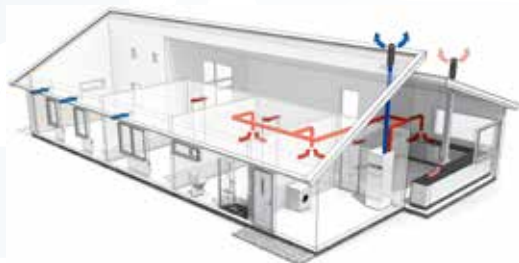
Figur 5.4 Brugsvandsvarmepumpe (som anvender rumluft som varmekilde).
