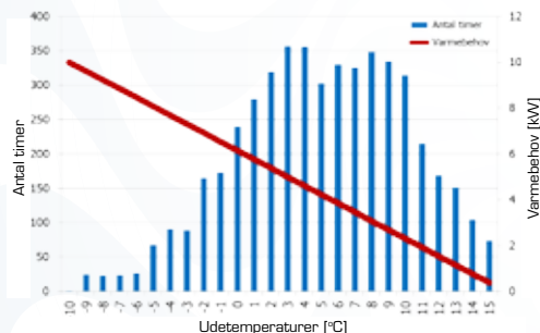
Figur 4.3. Eksempel på varmebehov og timeantal (DRY referencår) i afhængighed af udetemperaturen. Graferne anvendes som input til en SCOP beregning og til beregning af det årlige elforbrug.
